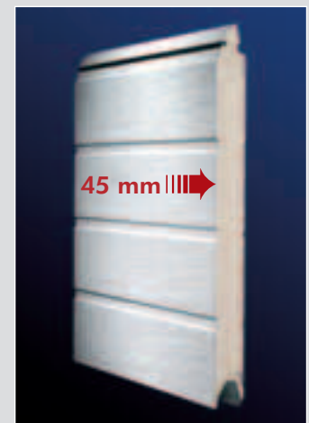
Schnittansicht Sektion Typ ISO 45 – doppelwandig, isoliert mit 45 mm FCKW-freiem PUR-Hartschaumkern.
